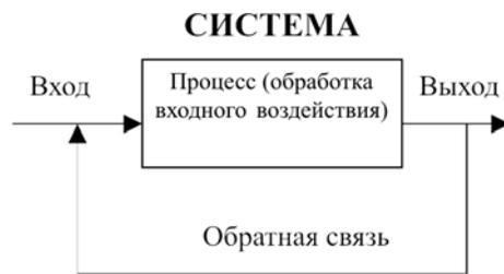
Рис. 3. Схема функционирования системы управления
