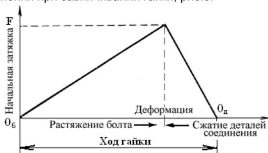
Рис. 3. Ход гайки и сила затяжки.
